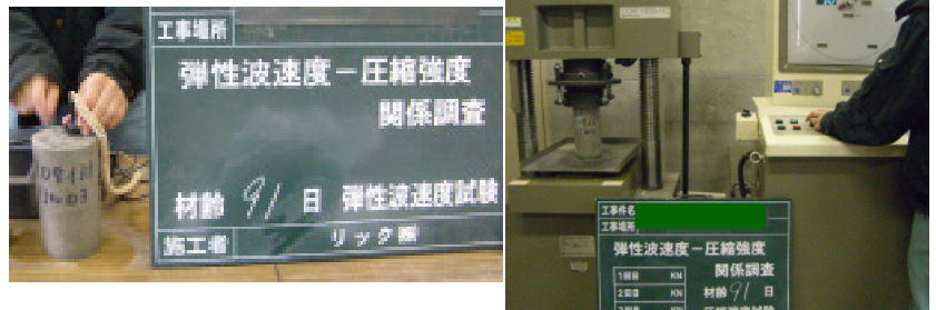
写真 1 弾性波速度と圧縮強度の関係調査状況
