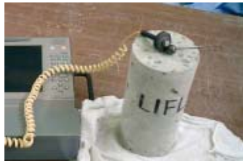
写真-1 円柱供試体での弾性波速測定状況
