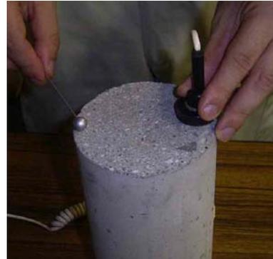
○打撃は円周の外端、センサは対向端部に設置して測定してください
