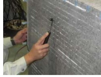
写真-1 接触時間法の測定状況
