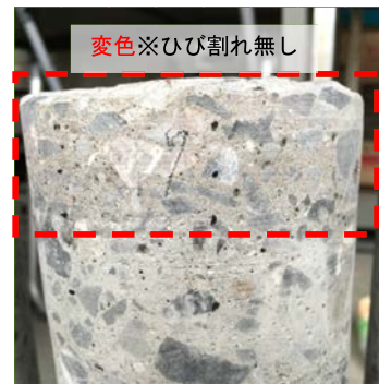
写真-2 採取したコアの外観状況（採取位置：幅 550mm）
