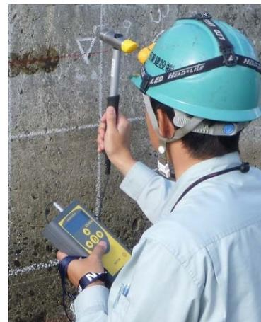
写真-1 機械インピーダンスの測定状況
