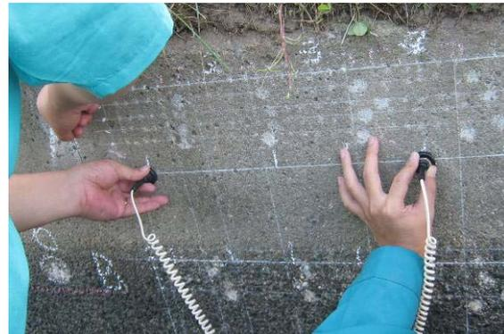
写真-2 弾性波速度測定状況
