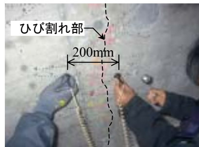
写真2 レイリー波速度測定状況
