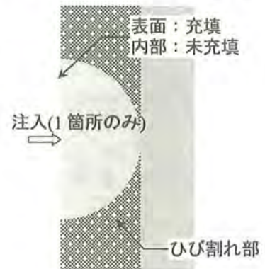
図4 ひび割れ注入状況
