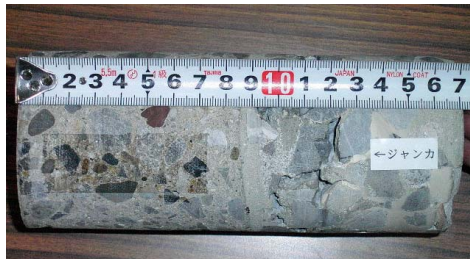
写真1 実験に用いた円柱供試体（左：ジャンカ部、右：健全部）
