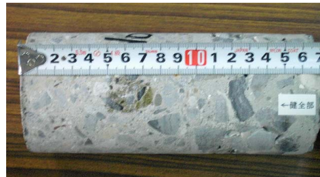
写真1 実験に用いた円柱供試体（左：ジャンカ部、右：健全部）
