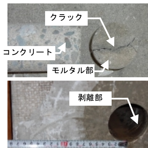
写真-3 測定例柱Bでのコア採取結果
